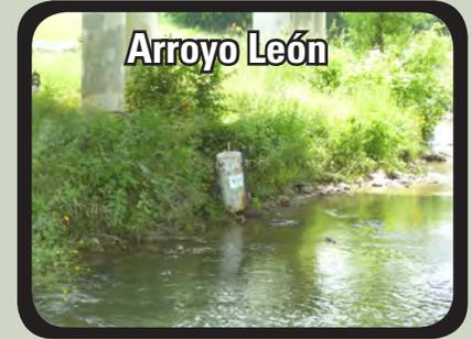
Las muestras de sedimentos en **suspensión** se colectaron en botellas diseñadas para muestreo pasivo (25 litros que se encontraban dentro de un cilindro de acero) instaladas cerca de los cauces fluviales. La botella en el interior del cilindro se llena cuando llueve y sube el caudal. Las muestras de sedimentos en suspensión fueron aisladas de las aguas pluviales a través de un proceso de filtración.
