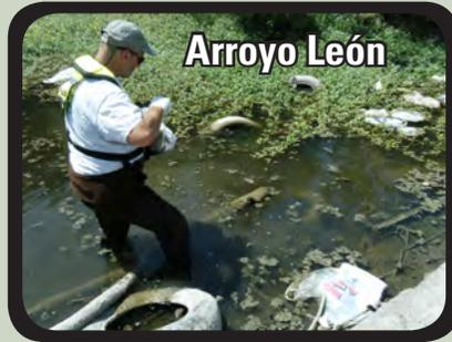
Las muestras de sedimentos tomadas **en cauce** son la combinación de muestras colectadas en múltiples zonas de deposición a lo largo de una sección del río a cada sitio. Los sedimentos fueron recogidos en un recipiente de vidrio, mezclados, y tamizados a un tamaño de grano estándar.
