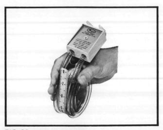
FIG. 36 - TUBE MANOMETER
