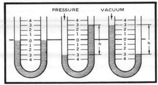
FIG. 35 - "U" TUBE MANOMETERS
