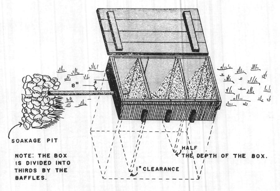
BAFFLE GREASE TRAP
