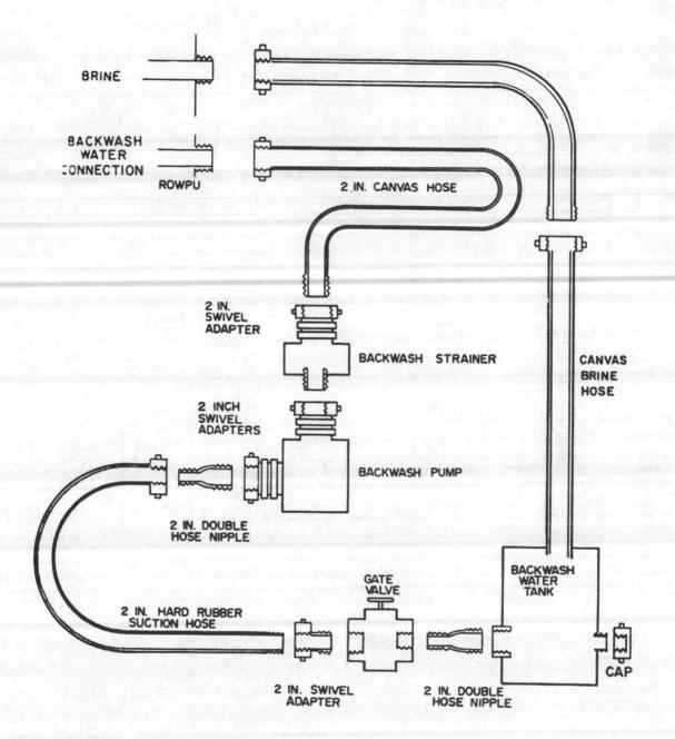
FIGURE 1-2. BACKWASH WATER SYSTEM
