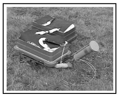
Figure 14-22. MK7 Antipersonnel Obstacle-Breaching System (APOBS).
