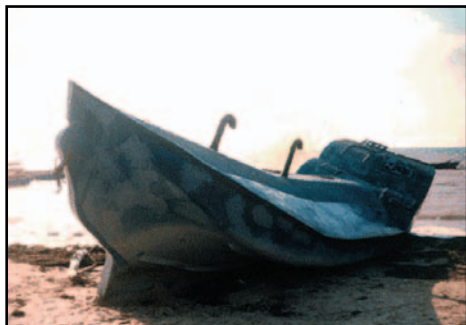
Semi-sumergible con compartimentos de carga sellados capturado en 1992. (Fuente: Armada Nacional de Colombia).
