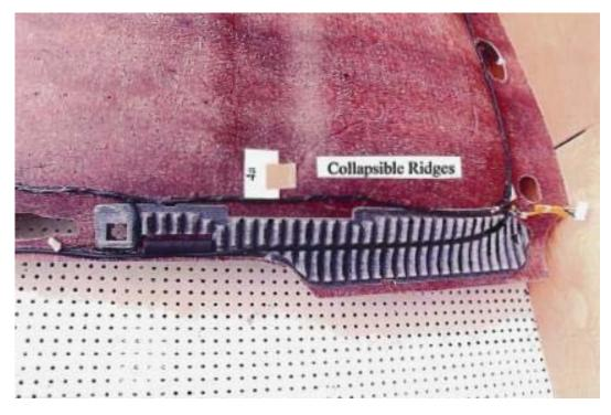
Figure 3: Collapsible Ridges<sup>9</sup>
