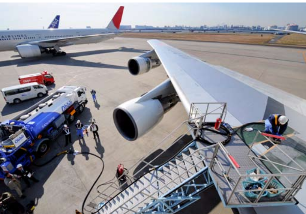
Cet avion de Japan Airlines utilise un mélange comprenant 50% de biocarburant et 50% de carburéacteur traditionnel. Plusieurs compagnies aériennes ont déjà effectué des vols d'essai avec du biocarburant.
